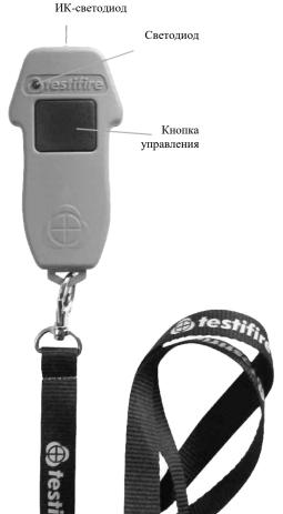
Устройство TESTIFIRE автоматически начинает тестирование при расположении под извещателем. Тем не менее, некоторые типы извещателей не могут автоматически начать проверку в некоторых обстоятельствах. В таких случаях **TESTIFIRE 25 ИК-пульт дистанционного управления** может использоваться для ручного запуска теста.
