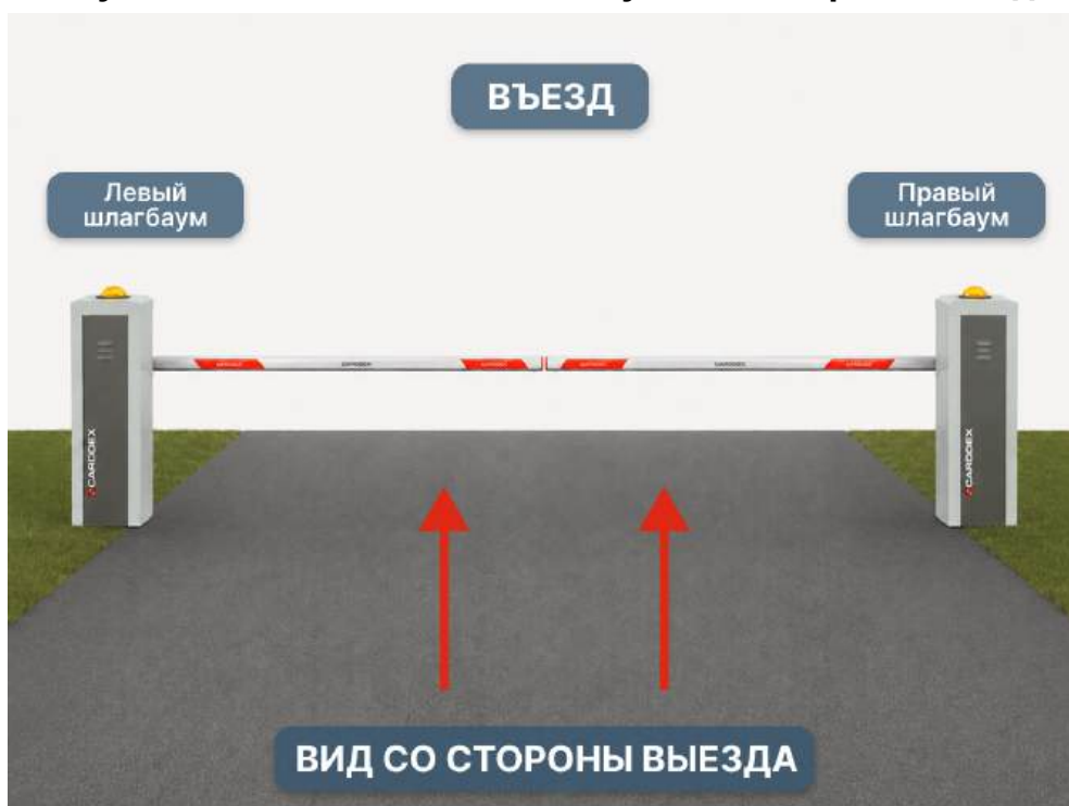
Рисунок 2. Расположение шлагбаумов со стороны выезда
