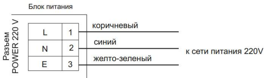
Рисунок 30. Схема подключения блока питания
