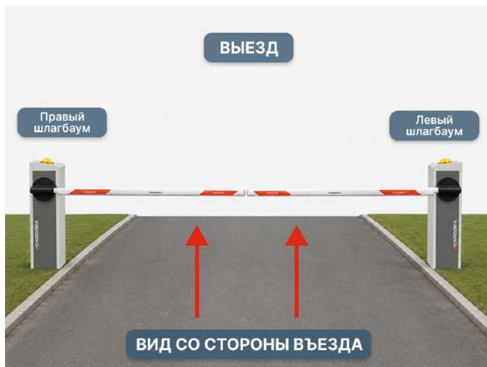
Рисунок 1. Расположение шлагбаумов со стороны въезда
