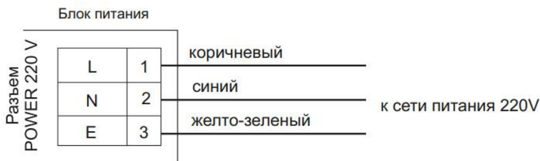
Рисунок 25. Схема подключения блока питания
