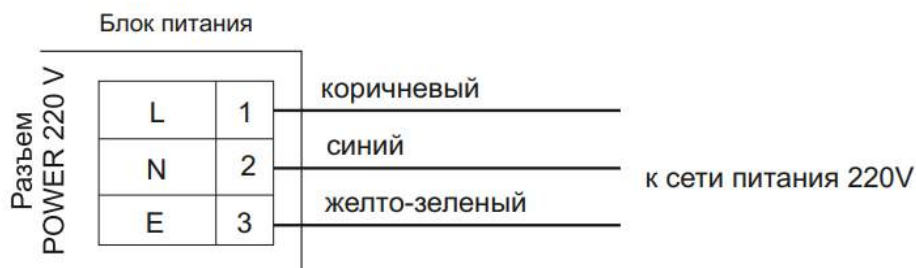
Рисунок 26. Схема подключения блока питания
