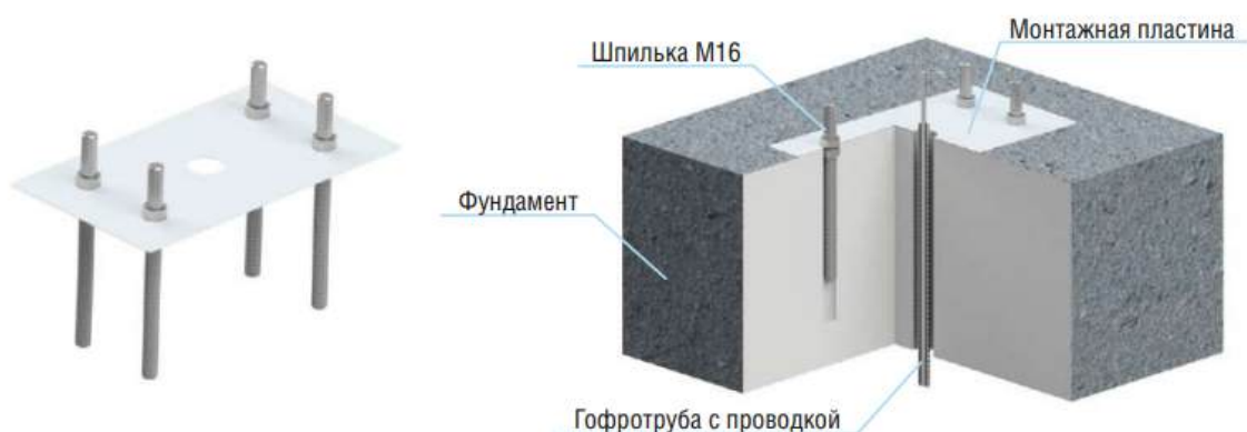
Рисунок 20. Устройство фундамента с монтажным комплектом.
