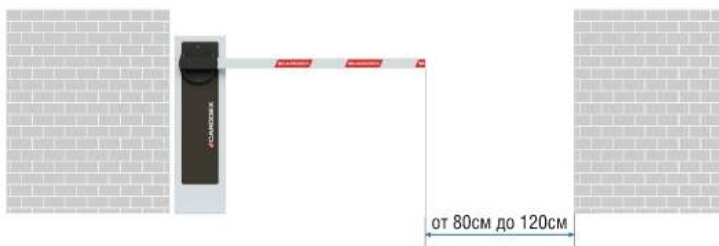
Установка шлагбаума с пешеходной зоной
