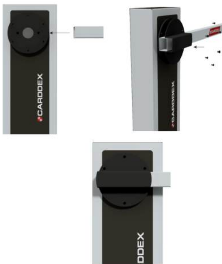
Рисунок 6.5.1 Установка стрелы на шлагбаум
