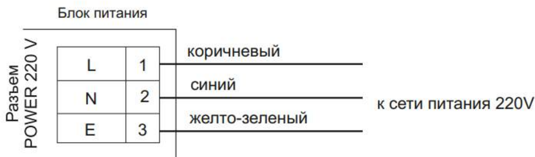
Рисунок 23. Схема подключения блока питания
