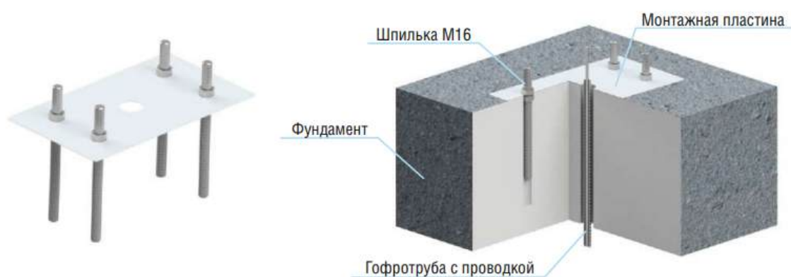
Рисунок 17. Устройство фундамента с монтажным комплектом.
