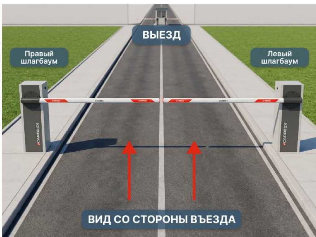
Рисунок 1. Расположение шлагбаумов со стороны въезда
